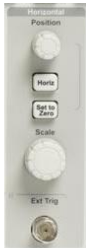
Figura 2.8: Comandos disponíveis para controle da escala horizontal.
