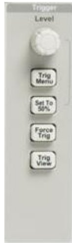
Figura 2.7: Comandos disponíveis para controle de “trigger”.
