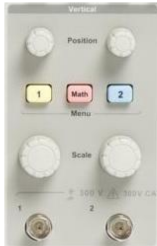
Figura 2.6: Comandos disponíveis para controle da escala vertical.
